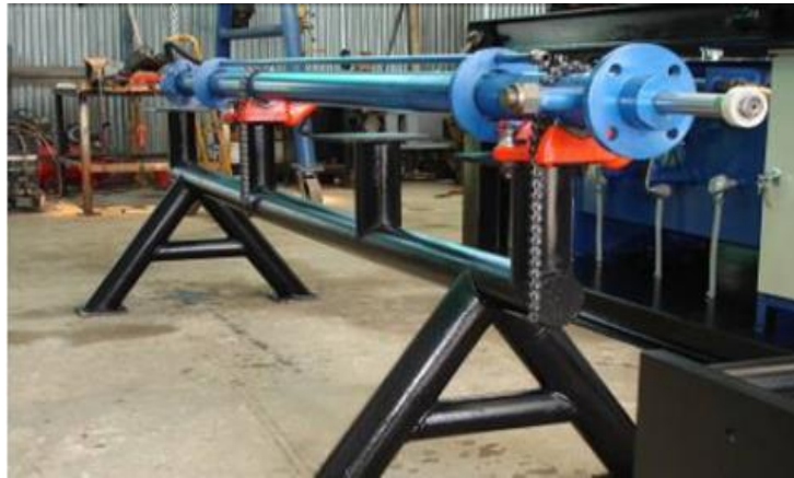
Figura 1.5 Actuador hidráulico de la unidad de bombeo mecánico SERINPET MINI.
