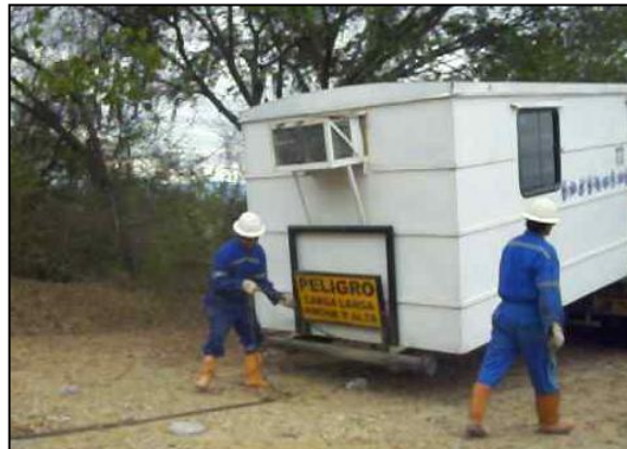
Figura N° 56. Soltar la cadena atada al vehículo auxiliar y a la carga.
