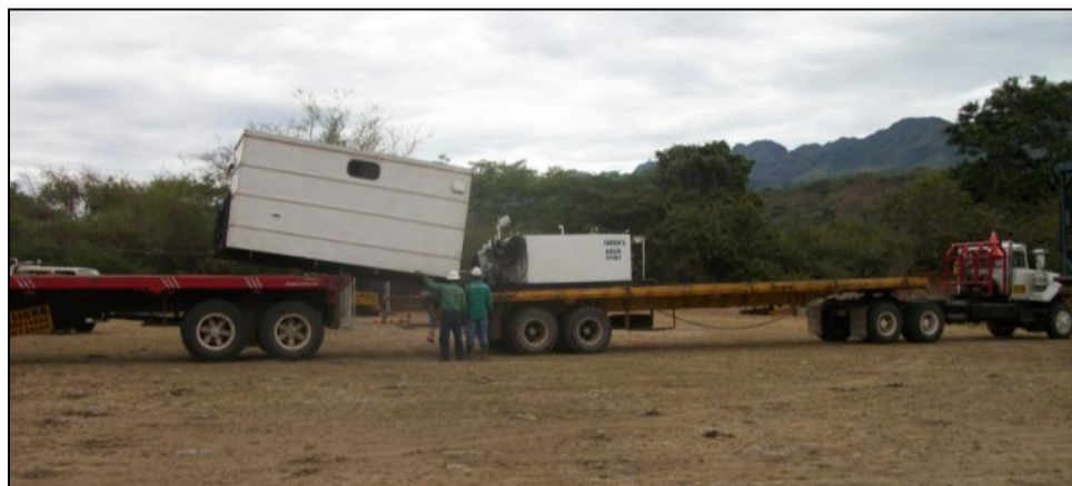
Figura N° 48. Retirar el cable del vehículo tracto camión atado a la carga.
