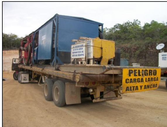
Figura N° 43. Señalizar los vehículos con avisos de seguridad.
