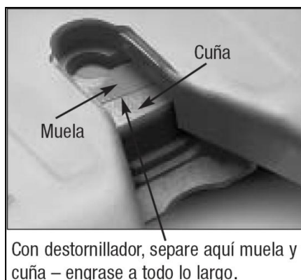
Figura N° 82. Engrasar las partes móviles de la quinta rueda.
