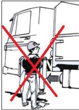
Figura N° 98. No se haga delante de las patas estabilizadoras.
