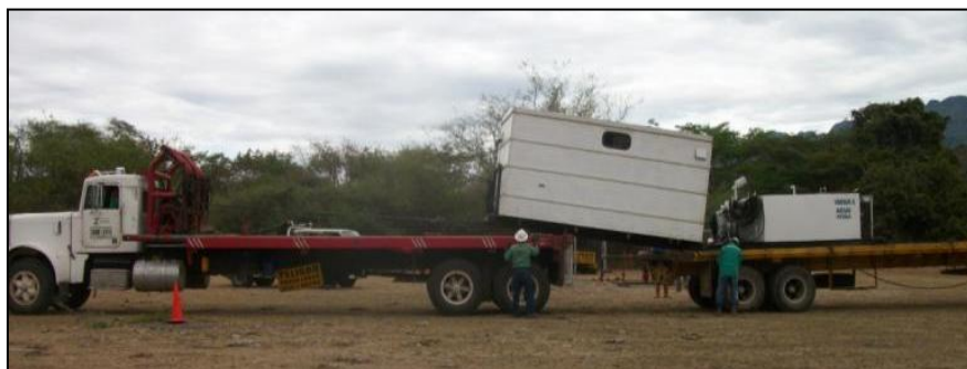
Figura N° 46. Traccionar la carga con el vehículo carro macho del vehículo tracto camión.
