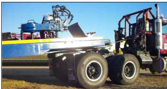
Figura N° 69. Acoplamiento para enganchar el perno rey del safety move con la quinta rueda del vehículo tracto camión.
