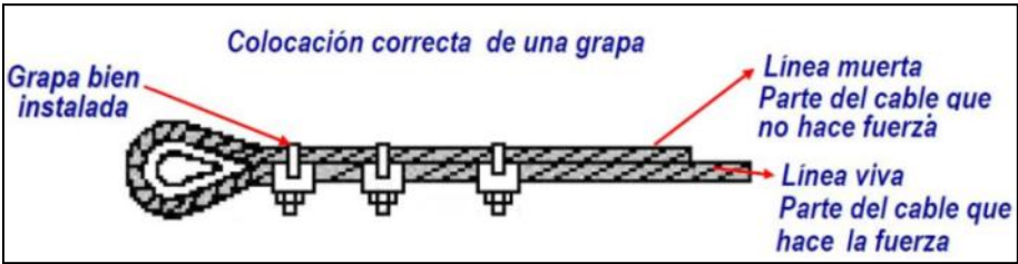
Figura N° 23. Grapa de cables.
