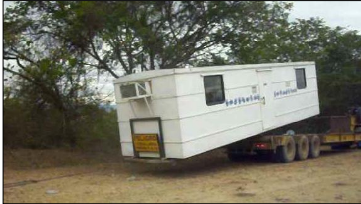
Figura N° 55. Desplazar la carga por el tráiler del vehículo tracto camión.
