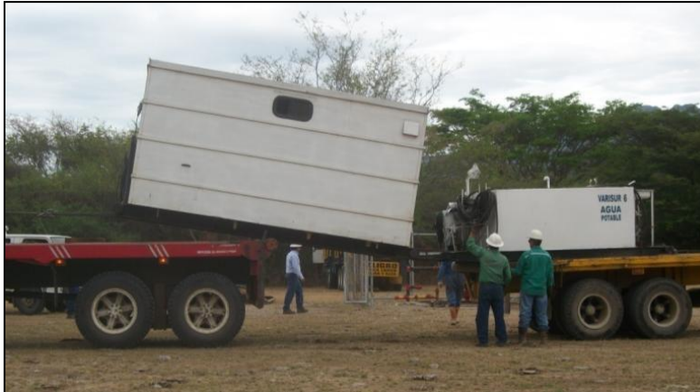
Figura N° 47. Traccionar la carga hasta ubicarla sobre la plataforma del vehículo carro macho.
