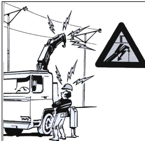
Figura N° 93. Asegurarse que la grúa no entre en contacto con cables eléctricos.
