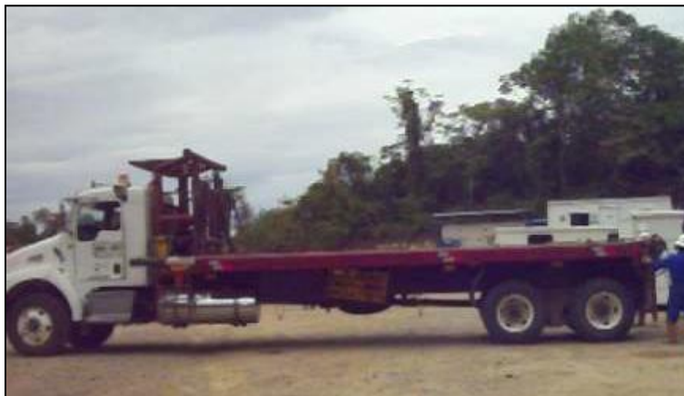
Figura N° 52. Asegurar el cable del vehículo carro macho sujetándolo con la estructura de la plataforma.
