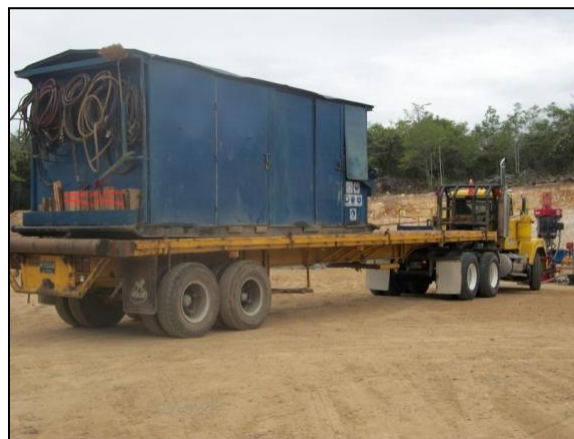
Figura N° 37. Ubicar la carga sobre la plataforma del vehículo tracto camión.
