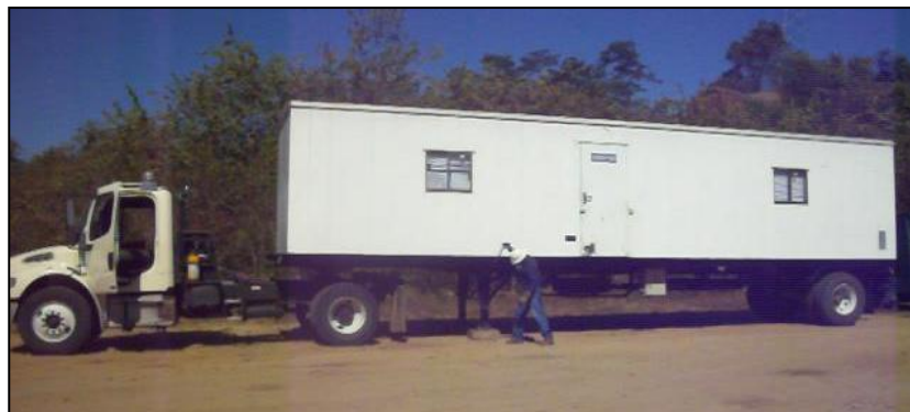
Figura N° 65. Levantar completamente el tren delantero del remolque.
