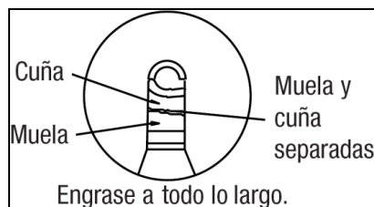
Figura N° 82. Engrasar las partes móviles de la quinta rueda.
