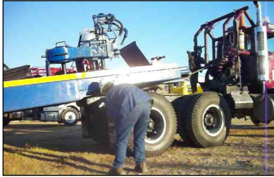
Figura N° 70. Inspeccionar visualmente la seguridad del acoplamiento.
