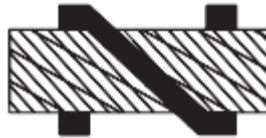
ILUSTRACIÓN 16: Arrollamiento cruzado Fuente: Catalogo Emcocables
