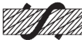
ILUSTRACIÓN 18: Arrollamiento alternado Fuente: Catalogo Emcocable
