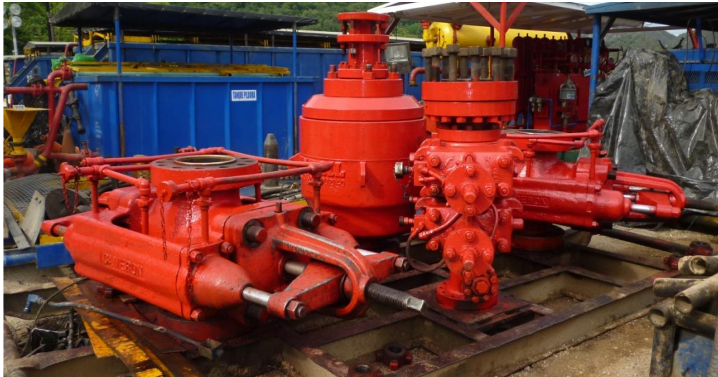
ILUSTRACIÓN 40: Preventoras de ariete, ciego y anular
