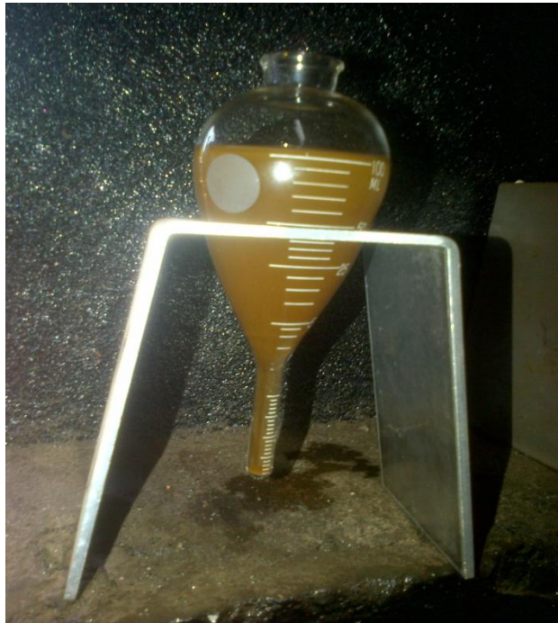
ILUSTRACIÓN 3. Solución Partículas Magnéticas con Agua
