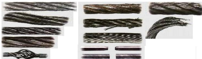
ILUSTRACIÓN 42: Daños frecuentes de los cables
