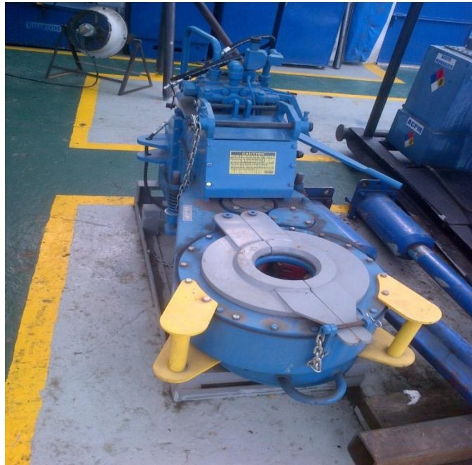
ILUSTRACIÓN 38: llave hidráulica de tubería
