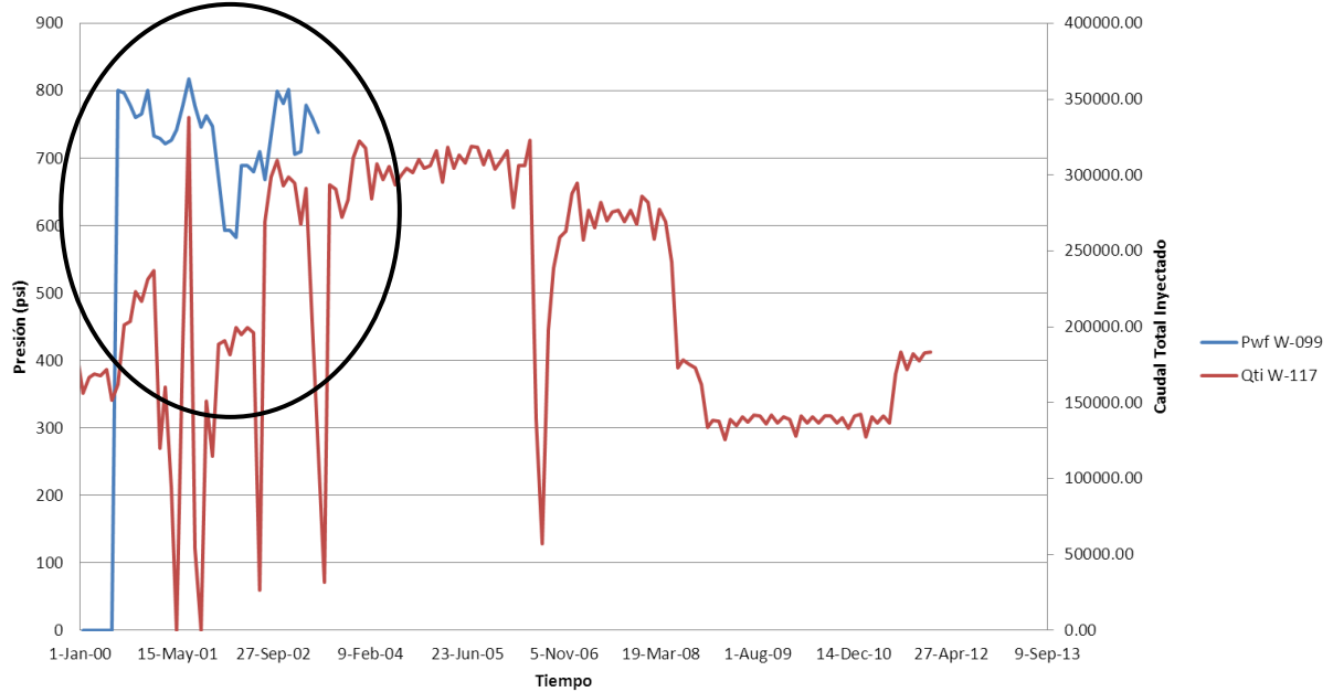
Figura 6. 20 Monitoreo de P_{wf} de W-099 y caudal de agua inyectada de W-117
