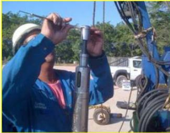
Figura 3.6. Prueba Hidrostática con 1500 psi
