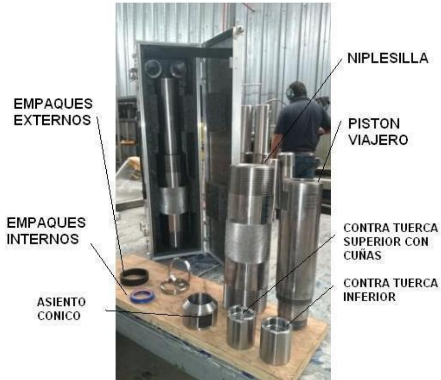
Figura 2.1b. Elementos que Componen la ABS Tool Fuente: Serinpet Y Autores
