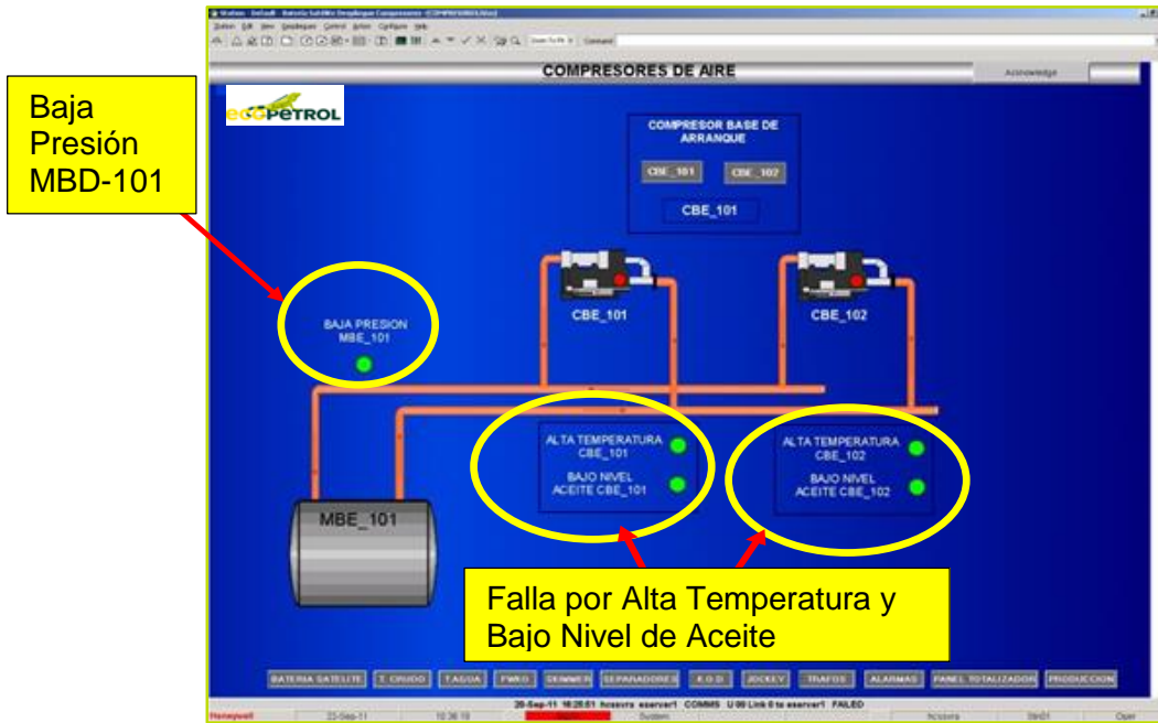
Figura 1. Sistema Supervisorio Experion/ Compresores de Aire.
