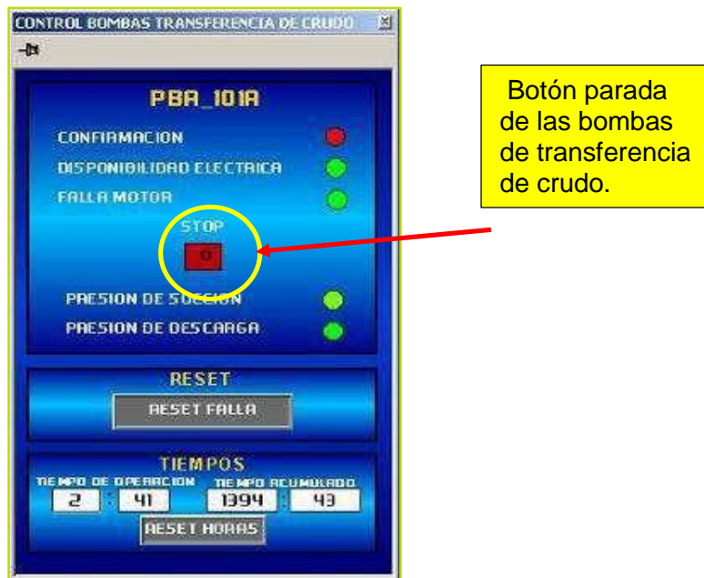
Figura 8. Sistema Supervisorio Experion – bombas de Transferencia de Crudo.
