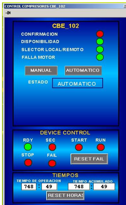
Figura 7. Posición manual/automático compresores de aire sistema Experion.
