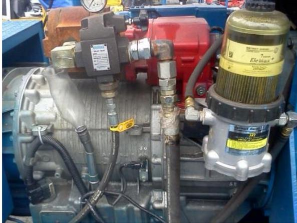
**ILUSTRACION 53:** Transmisión Allison Series 4700, equipo carrier Varisur 4. Fuente: Varisur y Compañía Ltda. 2014
