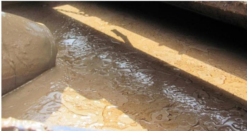
**ILUSTRACION 9:** Lodos base agua. Fuente: Zeal Environmental Technologies Limited.
