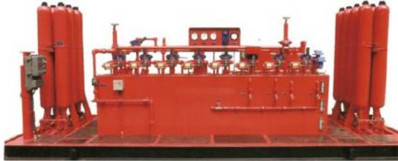
**ILUSTRACION 19:** Acumuladores de presión, BOP Control System BCU840-8 Sunda. Fuente: Manual Composite Catalog Sunda Corporation
