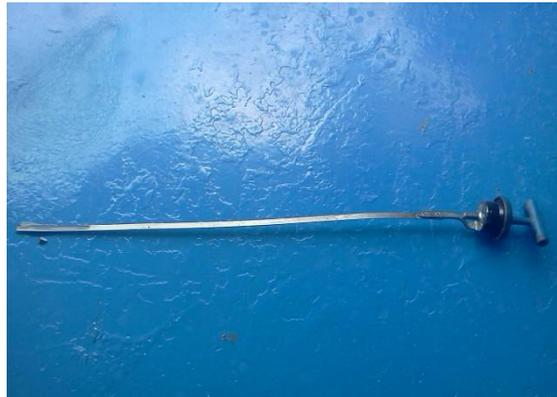
**ILUSTRACION 67:** Inspección visual del nivel de aceite de un motor Detroit Diesel 8V-71. Fuente: Varisur y Compañía Ltda. 2014
