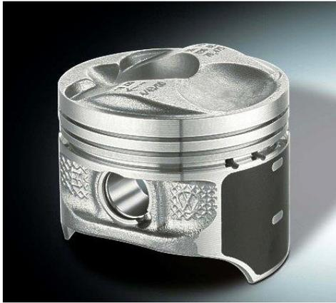
**ILUSTRACION 35:** Pistón de un motor diésel.
