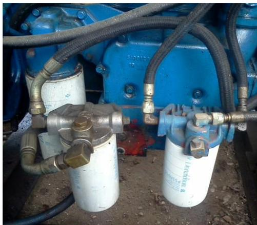
**ILUSTRACION 69:** *Filtros de aceite de un motor Detroit Diésel 8V-71. Fuente: Varisur y Compañía Ltda. 2014*
