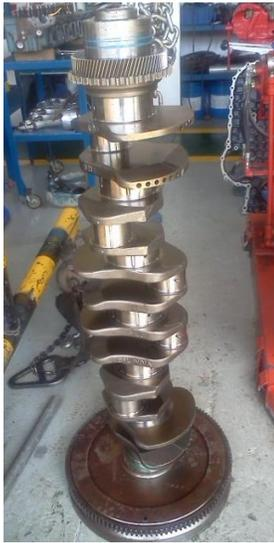
**ILUSTRACION 30:** Cigüeñal de motor Detroit Diesel Series 60. Fuente: Varisur y Compañía Ltda. 2014
