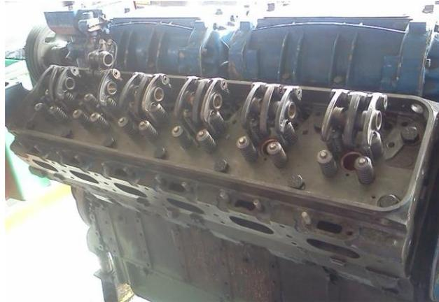
**ILUSTRACION 32:** Culata siendo ensamblada en el bloque de un motor Detroit Diésel Series 71. Fuente: Varisur y Compañía Ltda. 2014
