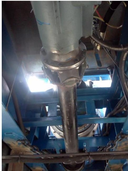
***ILUSTRACION 60:** Árbol de transmisión del carrier Varisur 4. Fuente: Varisur y Compañía Ltda. 2014*
