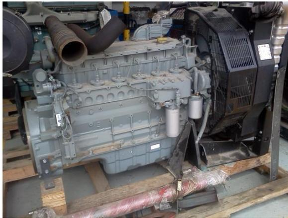
**ILUSTRACION 20:** Motor diésel de combustión interna, cuatro (4) tiempos Deutz BF6M 1013. Fuente: Varisur y Compañía Ltda. 2013
