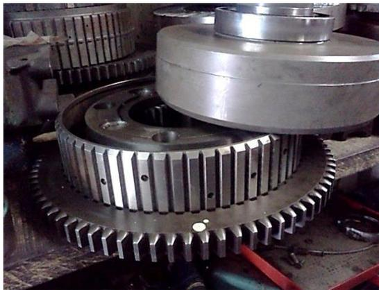
**ILUSTRACION 54:** Piñón de una transmisión Allison Series 4700. Fuente: Varisur y Compañía Ltda 2014
