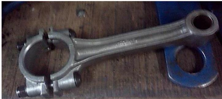
**ILUSTRACION 37:** Biela de motor Detroit Diésel Series 71. Fuente: Varisur y Compañía Ltda. 2014
