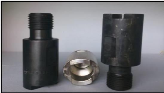
**Ilustración 27. BUSHING, VALVE ROD.**
