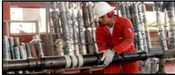
**Ilustración 1. Empaque para pruebas de inyectividad**
