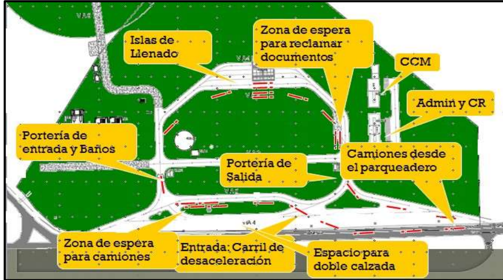
Figura 21. Instalaciones y servicios llenadero de GLP
