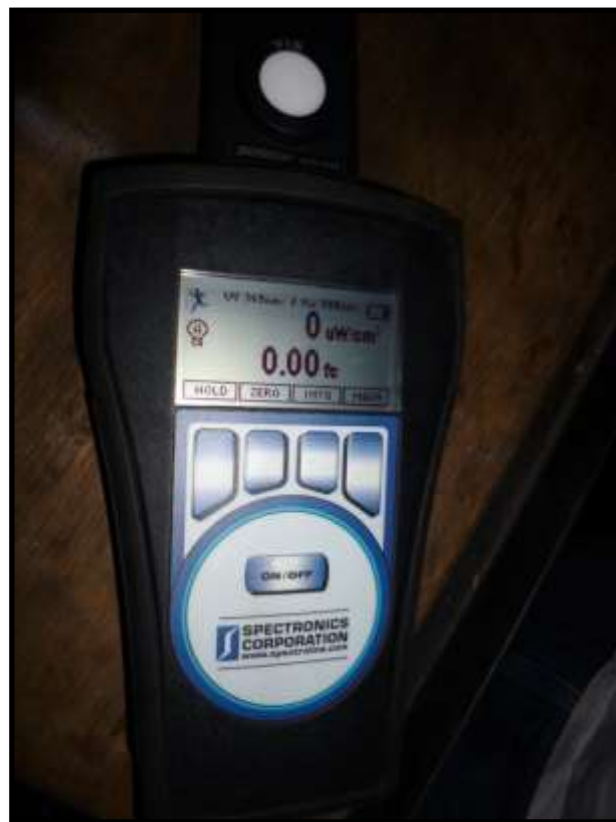
20. Verificación de intensidad lumínica con el radiómetro
