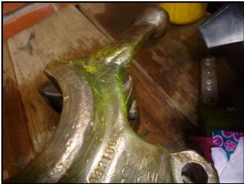
8. Pieza inspeccionada con partículas magnéticas
