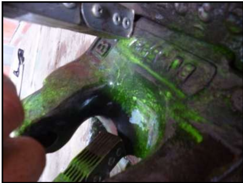
4. Pieza inspeccionada con partículas magnéticas
