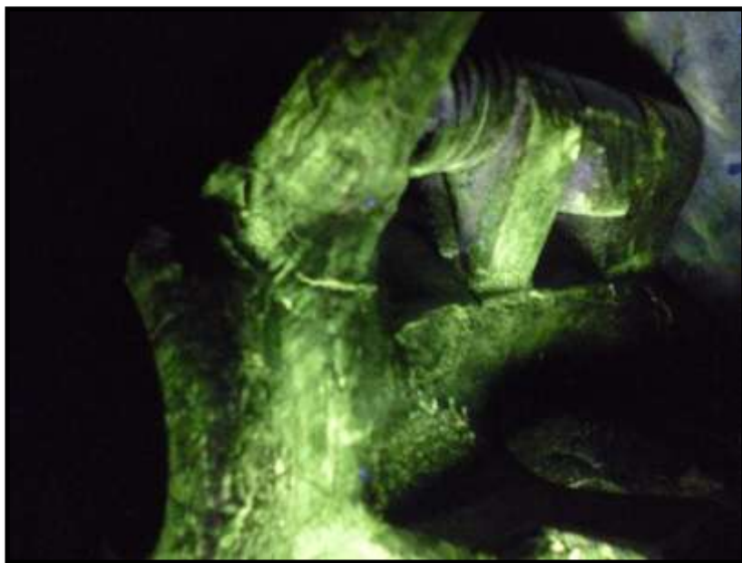
10. Discontinuidades en la pieza inspeccionada con partículas magnéticas
