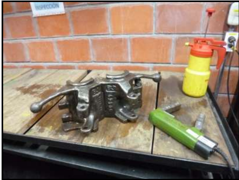
9. Pieza inspeccionada, yoke y dispersante de partículas magnéticas
