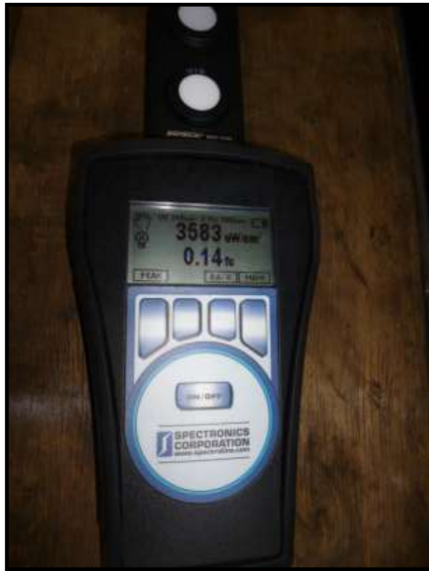
21. Verificación de intensidad lumínica con el radiómetro
