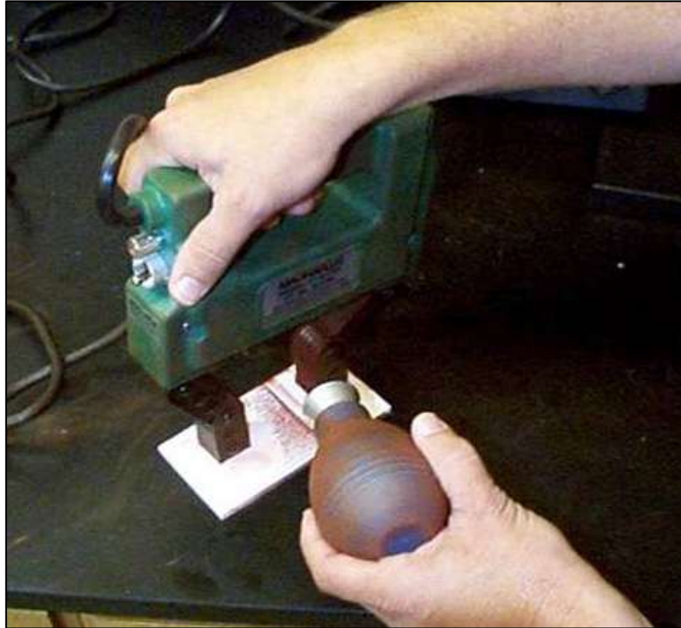
Figura 30: Aplicación de partículas Magnéticas secas Fuente: Testek.
