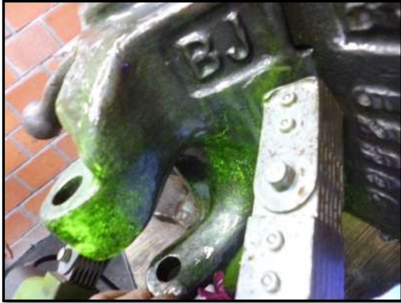
5. Pieza inspeccionada con partículas magnéticas
