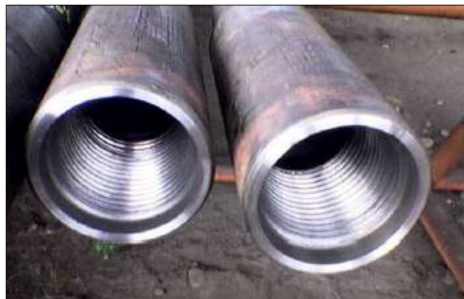
Figura 40: Sellos Reparados (Refacing). Fuente: Autores
