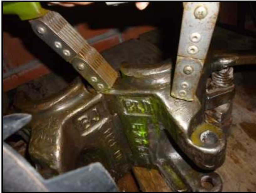
13. Pieza inspeccionada con partículas magnéticas
