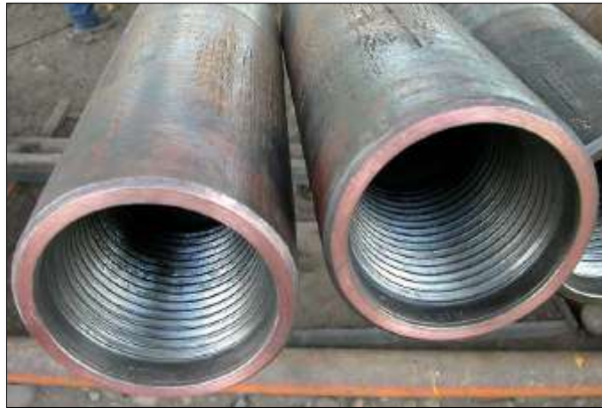
Figura 41: Sellos reparados y cubiertos con protección de cobre (Refacing). Fuente: Autores
