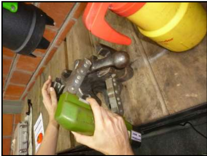
16. Pieza inspeccionada, yoke, lámpara UV y dispersante de partículas magnéticas
