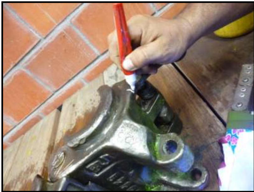
6. Señalización de discontinuidades encontradas en la pieza
