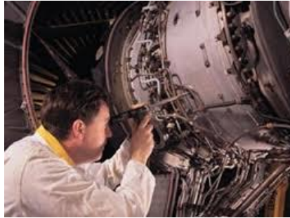
Figura 10 Persona utilizando el boroscopio en lugar de difícil acceso al ojo humano. Fuente: Página ILOG.
