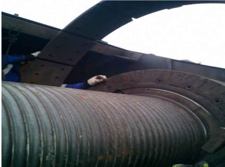
Figura 20. Cambio sunchos de frenos del malacate
