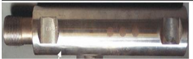
Figura 8 Shear coupling (Fuente: Base TDA)
