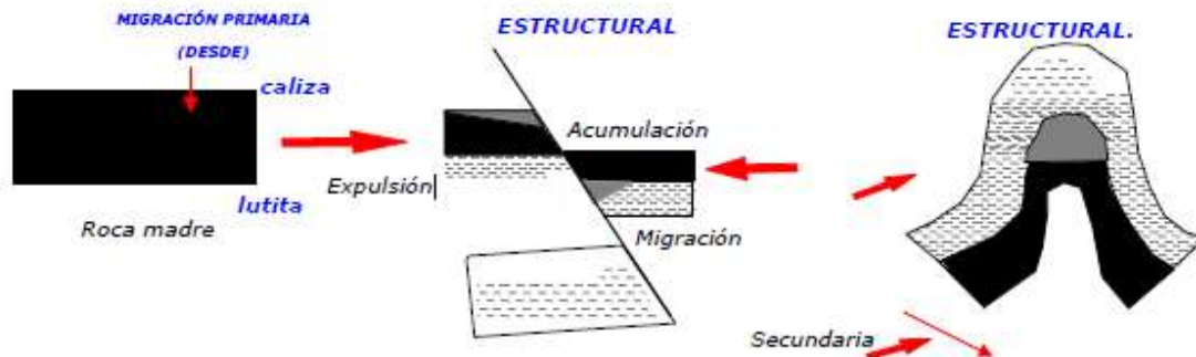
Figura 39 proceso de acumulación hidrocarburos
