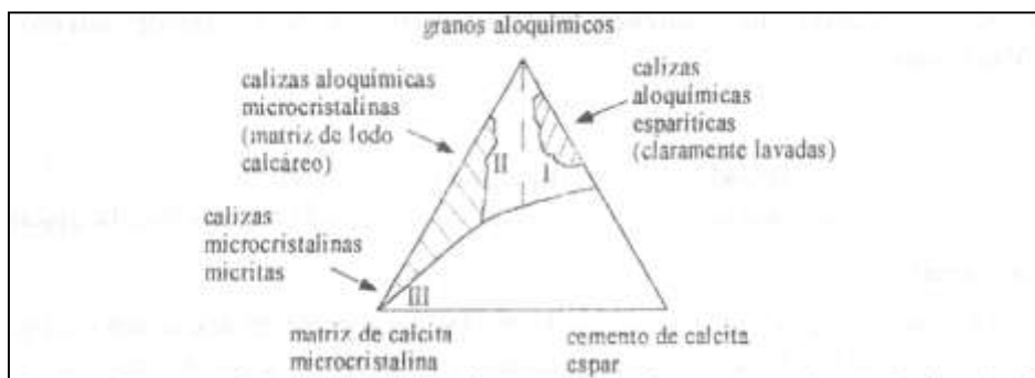
Figura 6 Clasificación De Rocas Calcáreas Basadas En Elementos Texturales, Se Ignora La Recristalización. Modificada De Folk 1974 Pág. 162
