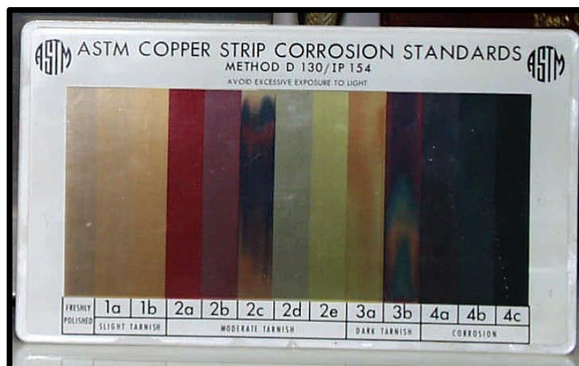
Figura 5. Fotografía de placa de estándares de corrosión en lámina de cobre. (Fuente: Los Autores)
