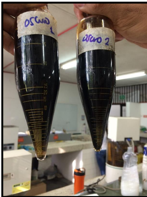
Fotografía 48. Determinación de % BSW por el método de la centrifuga el Oscuro
