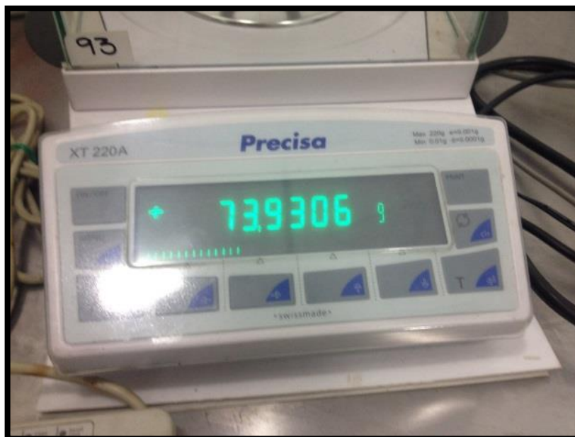
Fotografía 47. Determinación del °API por el método del picnómetro del rezumadero el Oscuro
