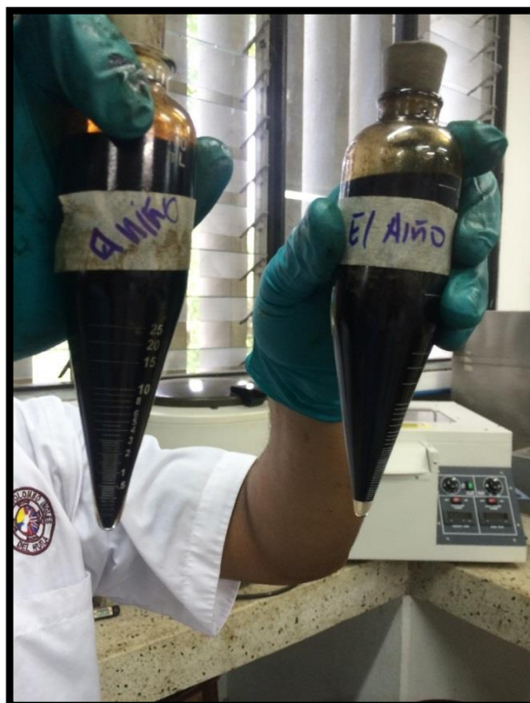
Fotografía 46. Determinación de % BSW por el método de la centrifuga el Niño
