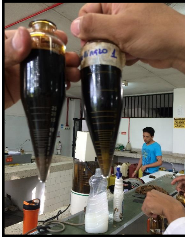
Fotografía 29 Determinación del % BSW por el método de la centrifuga del Rezumadero Gallinazo
