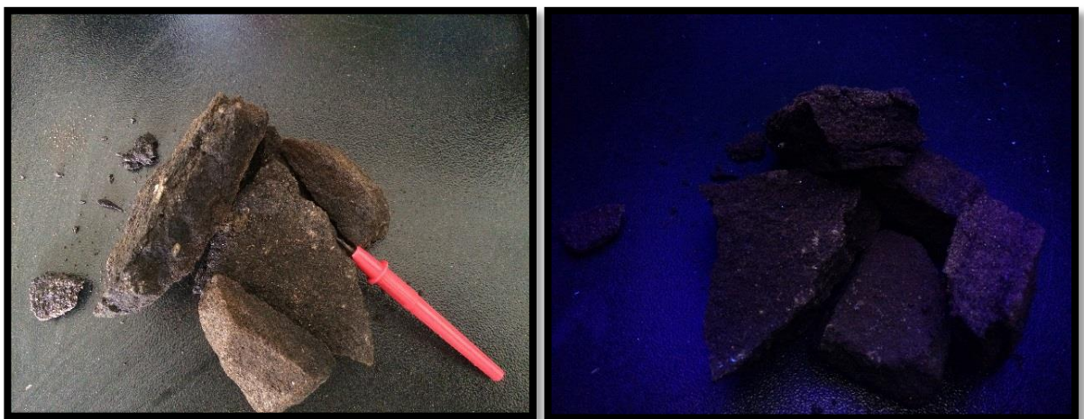
Fotografía 39 y 40. Muestra sin y con fluoroscopio, respectivamente del Rezumadero El Patillo
