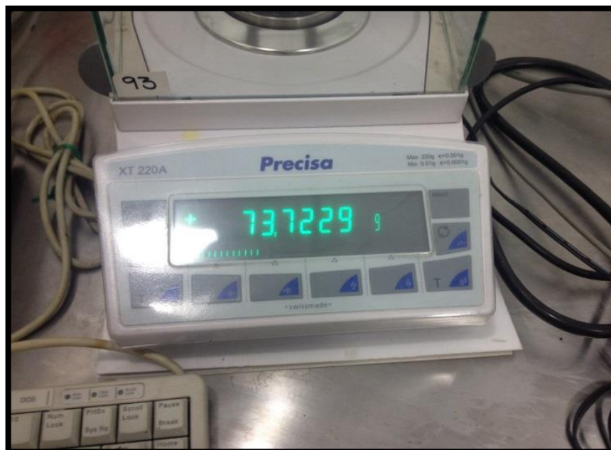
Fotografía 45. Determinación del \rho_{API} por el método del picnómetro del rezumadero el Niño
