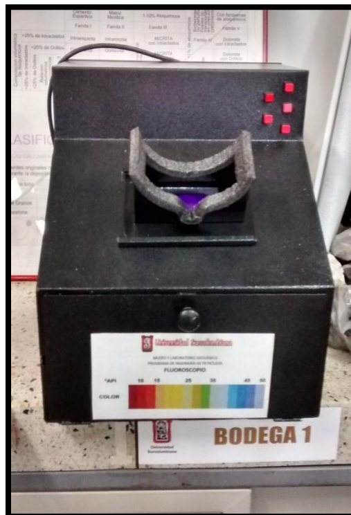
Ilustración 17. Fluoroscopio desarrollado por la Universidad Surcolombiana
