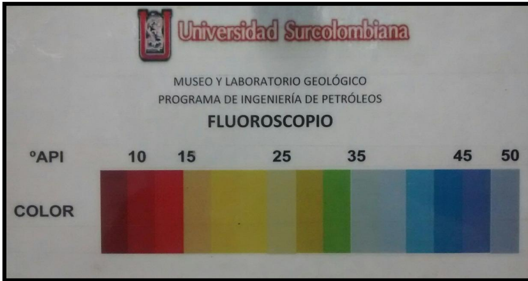
Ilustración 16. Escala para obtener los grados API del crudo impregnado en la roca.
