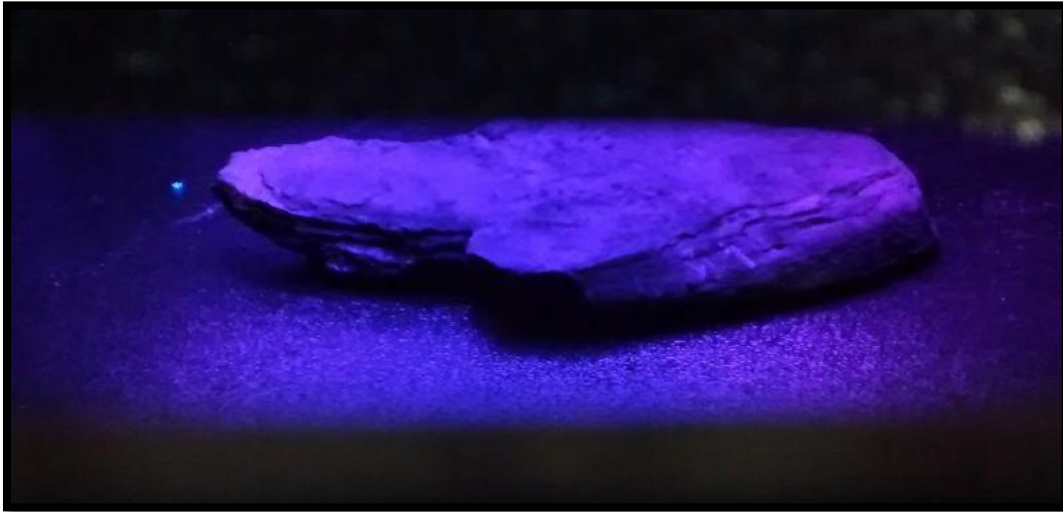
Ilustración 20. Por su tonalidad oscura en las impregnaciones de crudo nos indica que es un crudo pesado en rezumadero Popayo 17.
