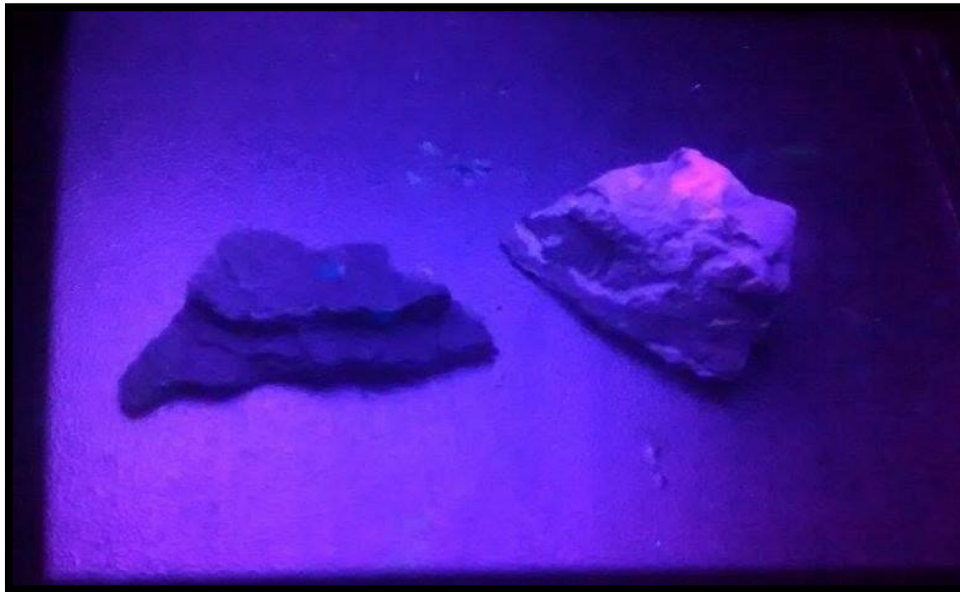
Ilustración 34. Fotografía muestras de roca Popayo 21 en el fluoroscopio.
