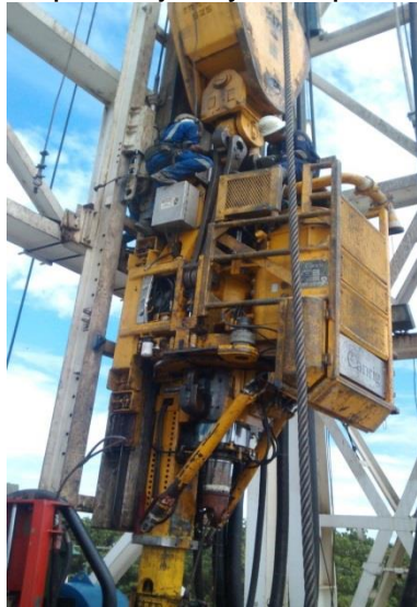
Figura 24. Retirando pernos entre el Bloque Viajero y el Top Drive
