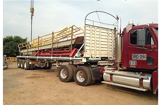
Figura 43. Cargas misceláneas del sistema de lodos (conexiones, barandas, mangueras)
