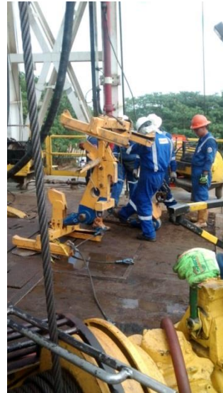
Figura 25. Ensamblaje de levantamiento del riel
