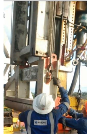
Figura 21. Instalando rodillo a la base del riel
