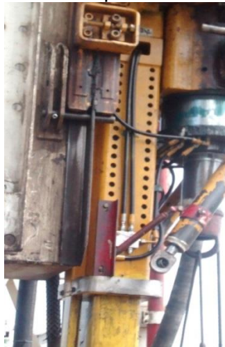
Figura 22. Perno inferior para asegurar el top drive
