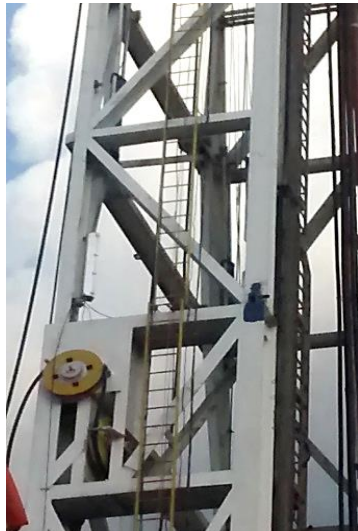
Figura 44. Sistema de poleas para bajar el mástil
