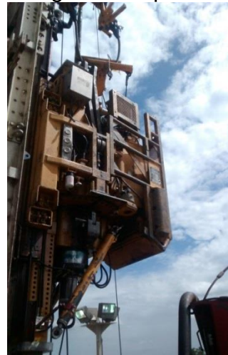
Figura 23. Perno superior para asegurar el top drive
