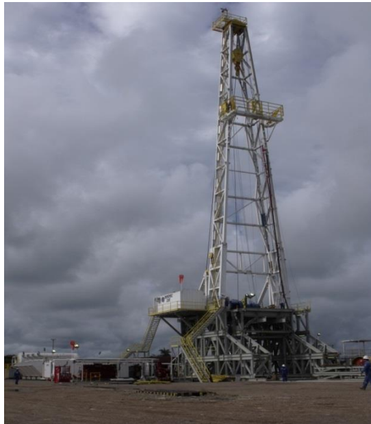
Figura 83. Mástil en posición final y pernado en la parte inferior con la subestructura
