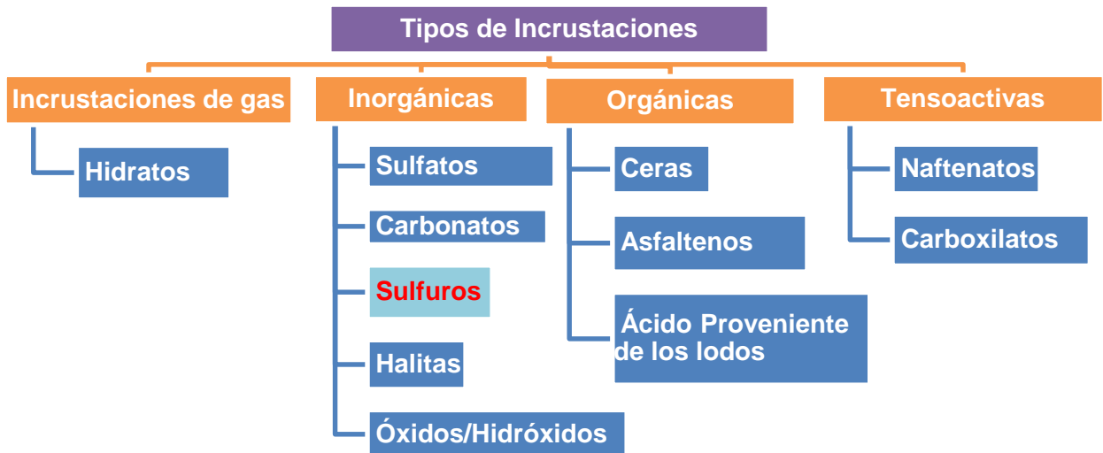
Figura 1.1 Clasificación de los diversos tipos de incrustaciones orgánicas e inorgánicas que se forman en un yacimiento petrolífero. (Okocha, 2011)
