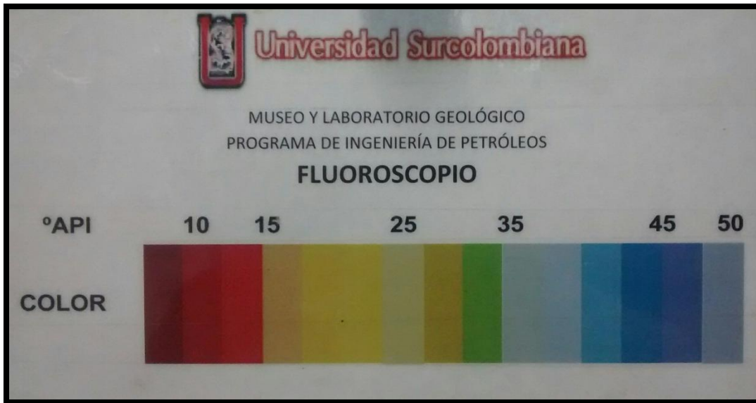
Fotografía 9 Escala para obtener los grados API del crudo impregnado en la roca.
