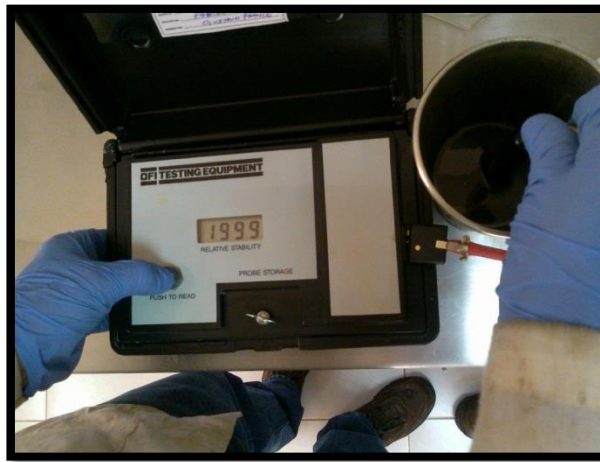
Ilustración 74. Test de Estabilidad Eléctrica. Al OBM de Higuera.
