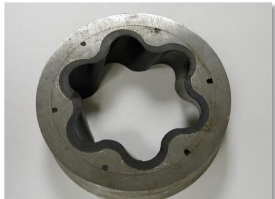
Ilustración 35. Parte elastómerica - motor direccional-Sección de Potencia
