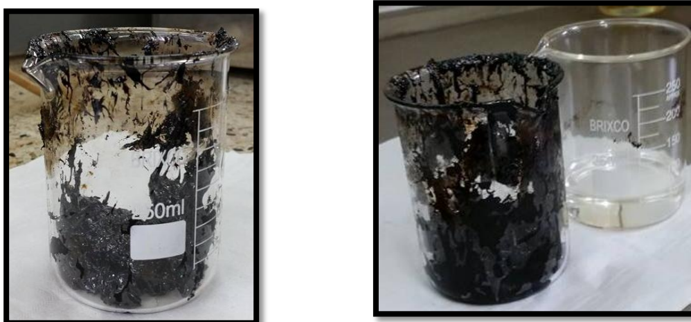
Fotografía 25. Determinación de la gravedad API usando Beaker para el crudo del indicio superficial de hidrocarburos de Las Juntas. (Las pruebas se realizaron en el Laboratorio de Crudos y Derivados del Petróleo en la Universidad Surcolombiana.)
