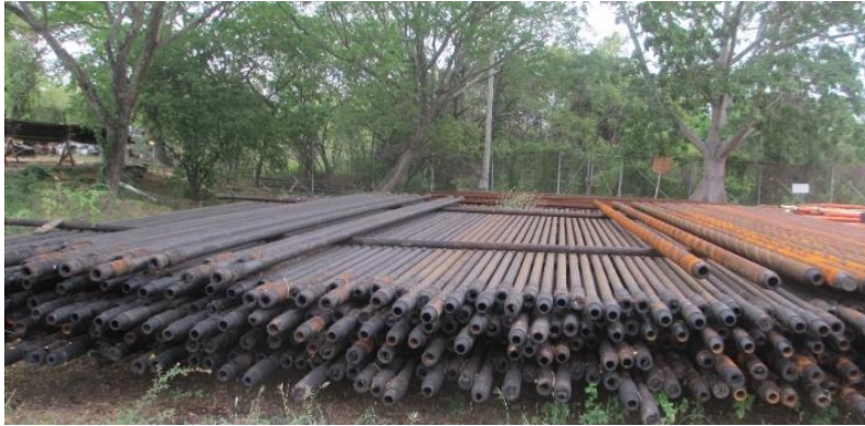
Ilustración 28. Falta de Protector para Pin
