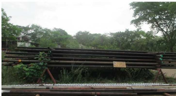
Ilustración 24. Altura mínima Inadecuada
