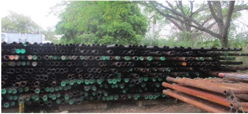
Ilustración 22. Mal estivado de Tubería
