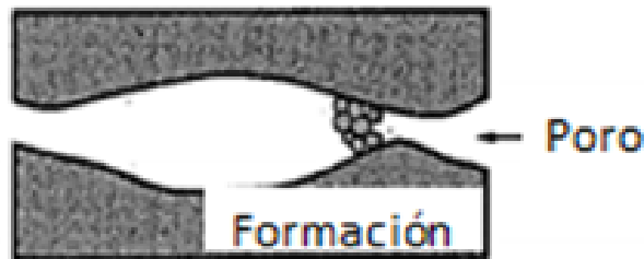
Figura 11. Efecto de taponamiento por depósitos de asfaltenos en el medio poroso.
