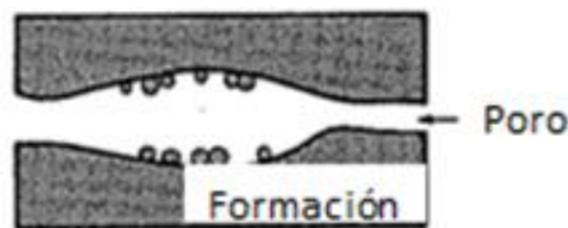
Figura 12. Efecto de cambio de mojabilidad por depósitos de asfaltenos en el medio poroso.
