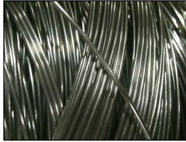
Imagen 5: Cable de acero de unidades de SlickLine
