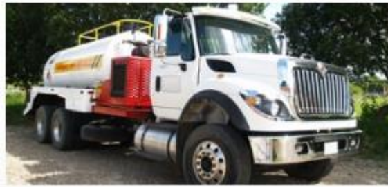
Figura 22 Camión de vacío (Fuente: Parko Services S.A)
