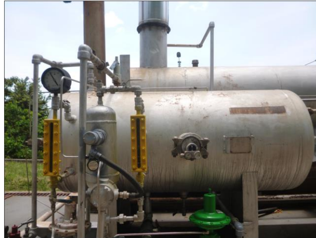
Fotografía 66. Separador de liberación instantánea (separador flash)
