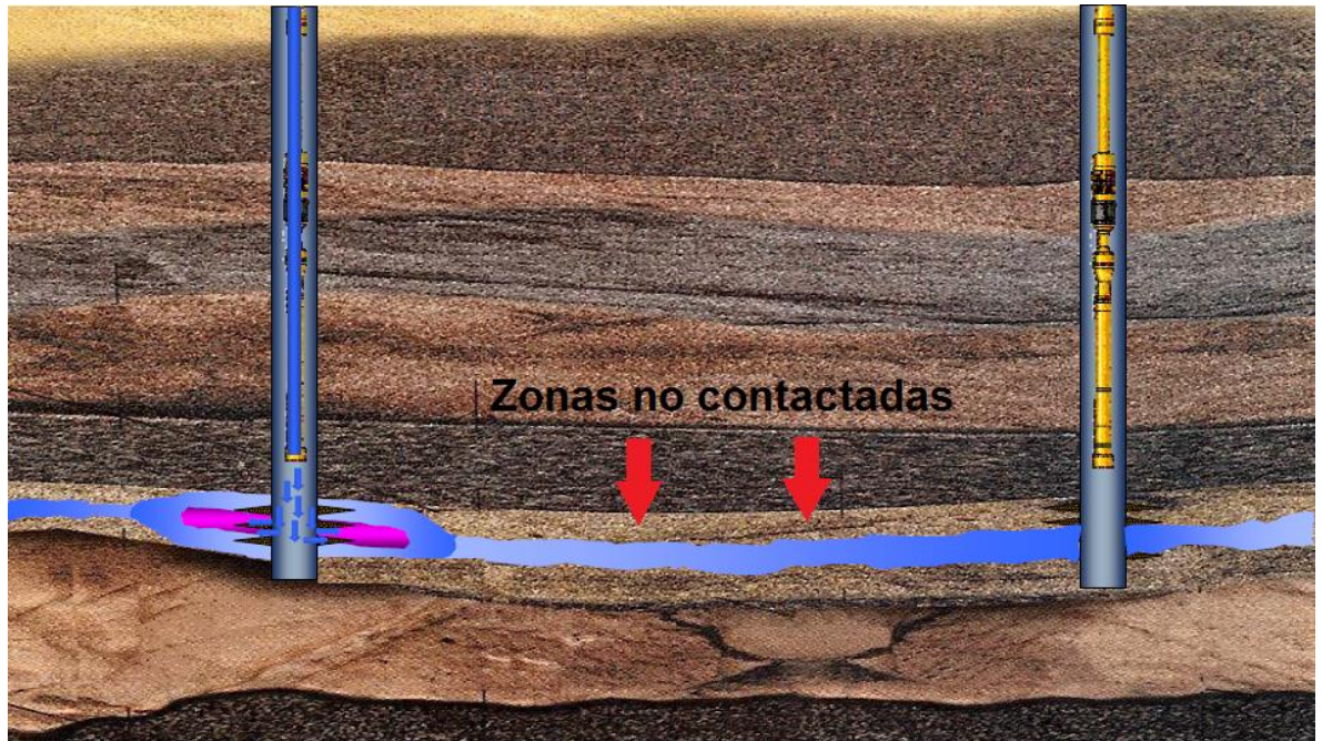
Figura 5: Canalización de la inyección en el yacimiento
