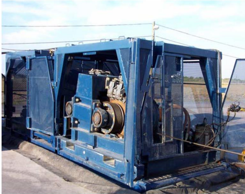
Fig. 29, Unidad de cable de alta precisión para cargas de alto o bajo peso. Tomado de IACD/SPE 99248 [29] (pág. 3)
