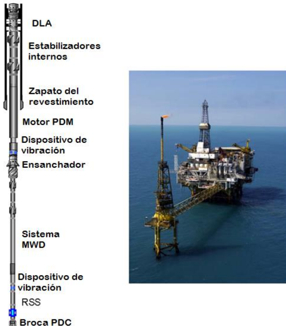
Fig. 45, Esquema del BHA direccional utilizado en la perforación del pozo (izquierda), y vista de la plataforma Eldfisk Bravo (derecha). Tomado de: IADC/SPE 112560 [34] (pág. 2 y 5)
