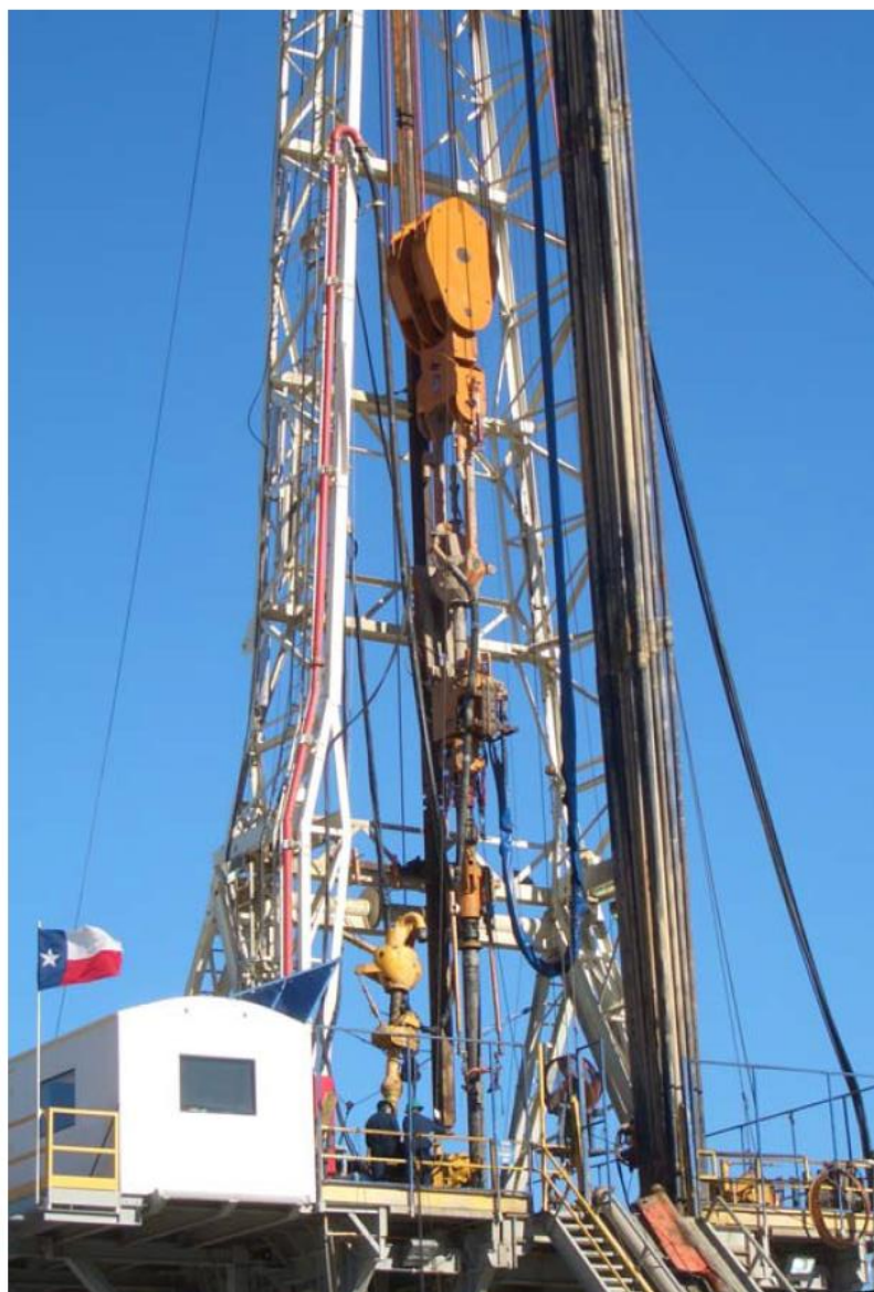
Fig. 31, Fotografía de un equipamiento de perforación con tubería de revestimiento. Tomado de IACD/SPE 99248 [29] (pág. 2)
