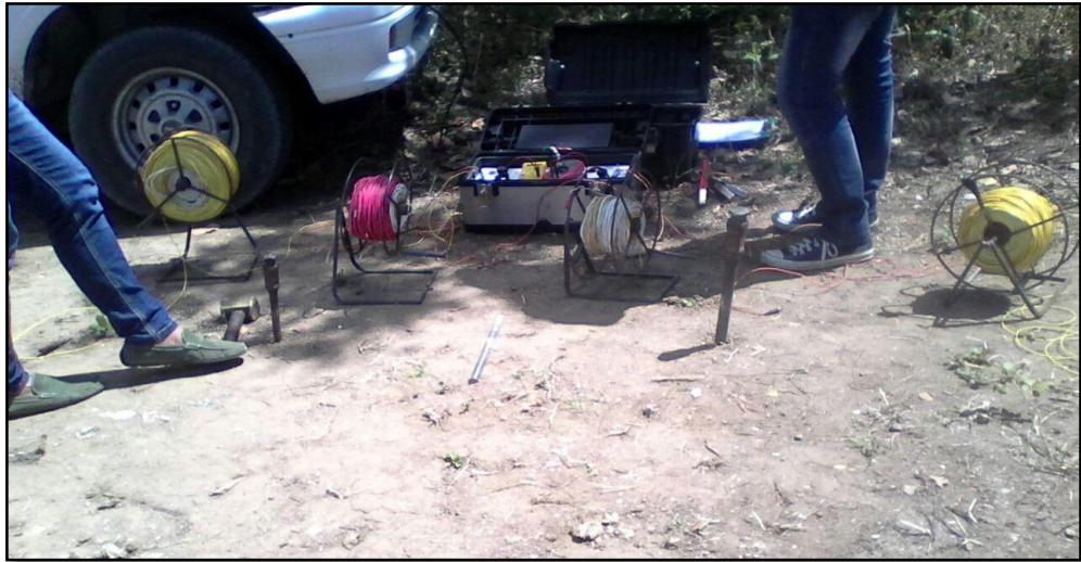
Fotografía 22. Equipo para sondeo geoelectrico C.A. Rubio, arreglo Schlumberger
