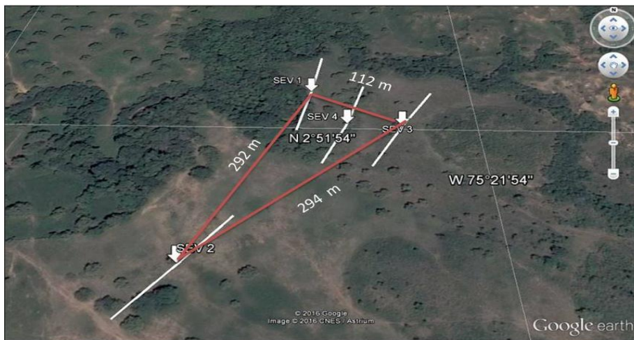
Figura 19. Ubicación y distancia entre los sondeos geoelectricos (Fuente: Google Maps versión libre)
