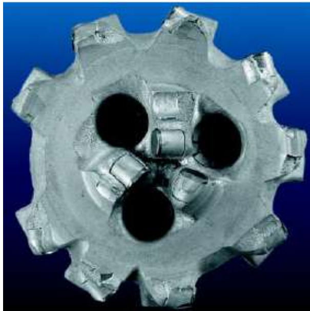
Figura 35. Anillamiento en una broca PDC.
