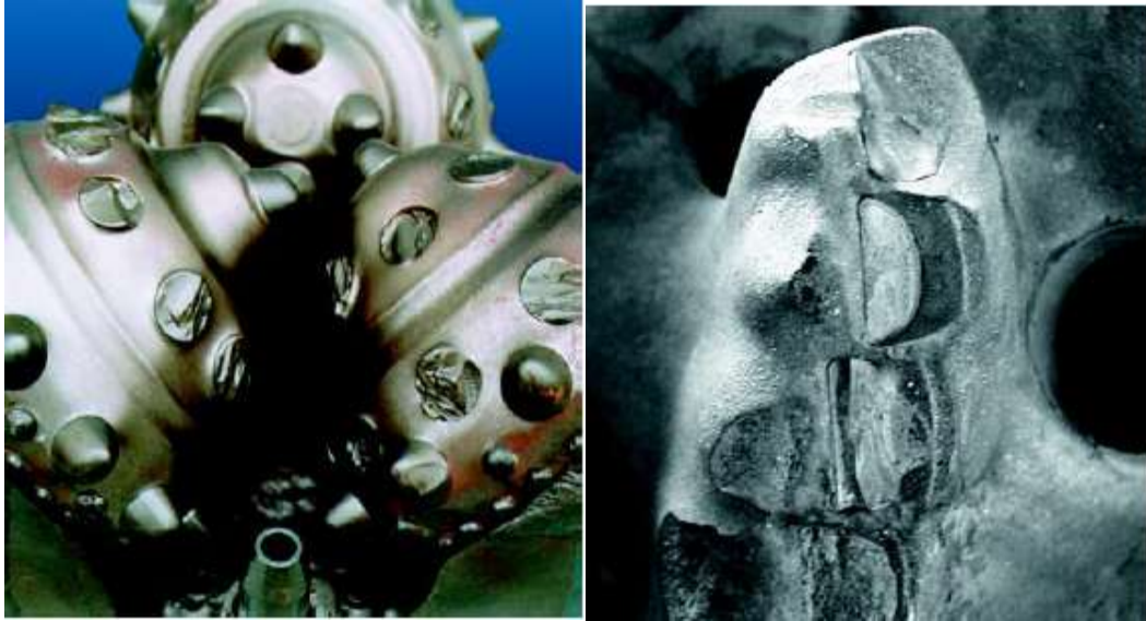
Figura 38. Diente roto-Cortador roto.
