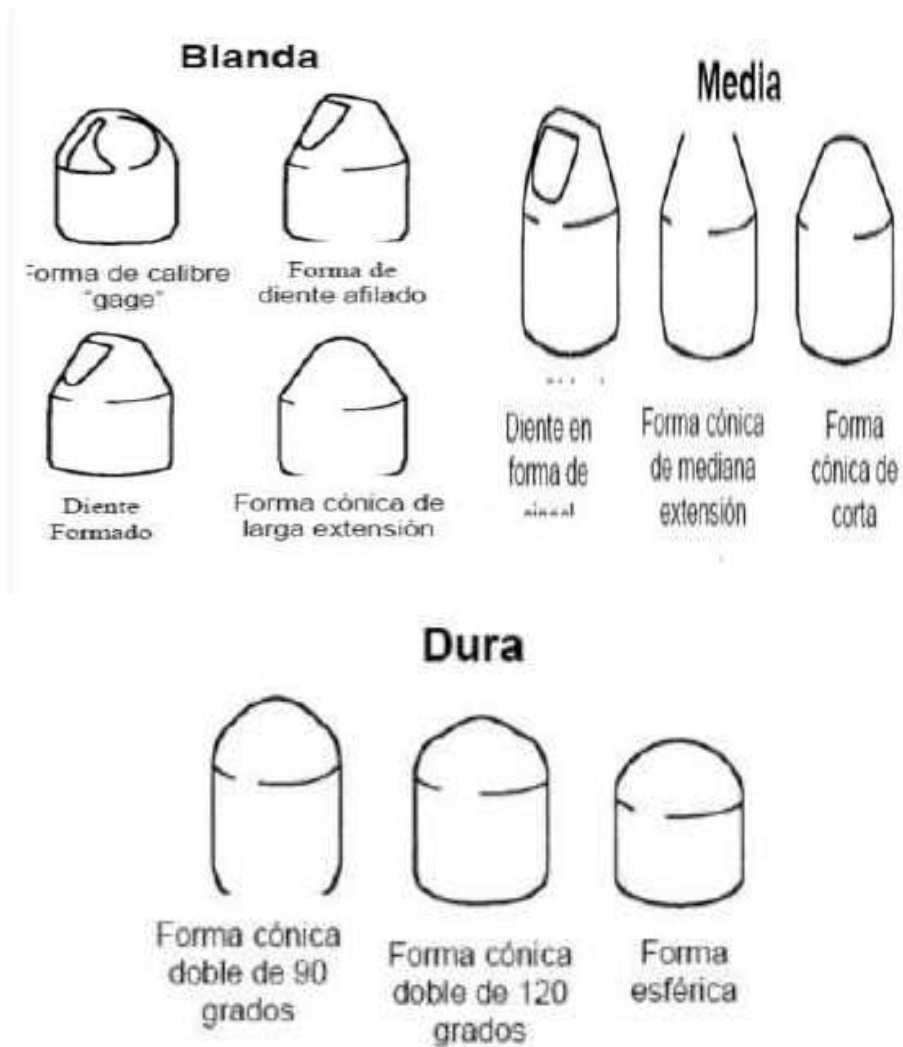
Figura 19. Tipos de Insertos de carburo de tungsteno.
