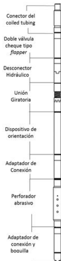
Figura 18. Ensamblaje de fondo de perforación abrasiva
