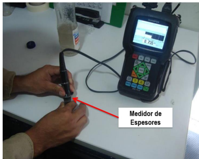
Figura 51. Monitorear espesor de accesorios de Well Testing durante la operación de Sand Jetting .
