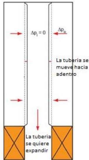
Figura 17. Balonamiento Inverso. Fuente: Well Completion Design
