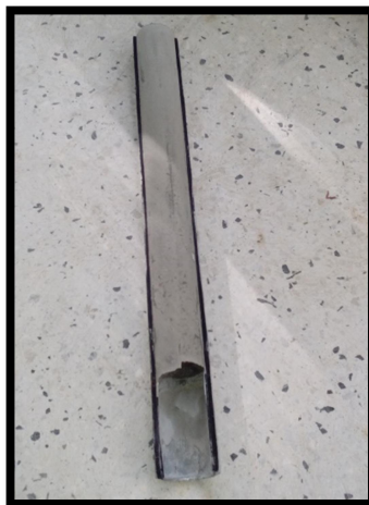
Figura 40. Espacio cementado prueba con aumento de P y T. Fuente: Autores
