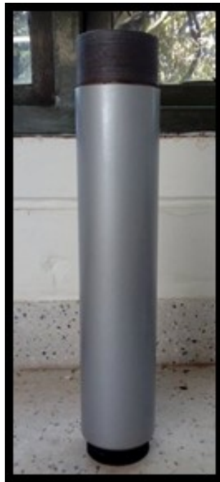
Figura 16. Celda de Presurización
