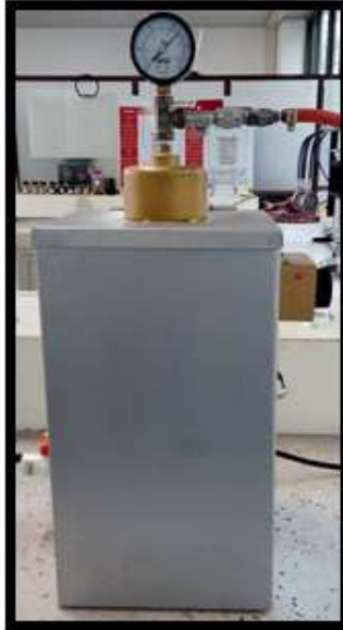
Figura 39. Montaje prueba con aumento de P y T. Fuente: Autores
