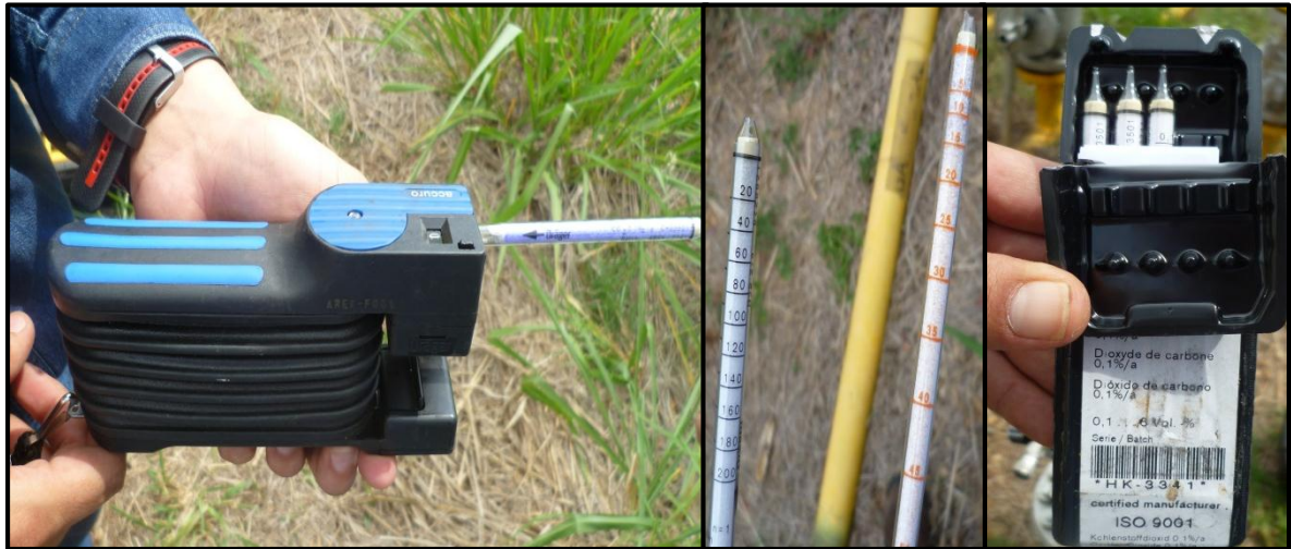
Figura 25. Determinación de contenido de CO 2 y H 2 S Monal y Satélite
