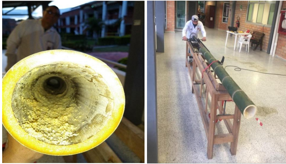
Figura 8. Perforación de tabique transversal y banco de perforación.
