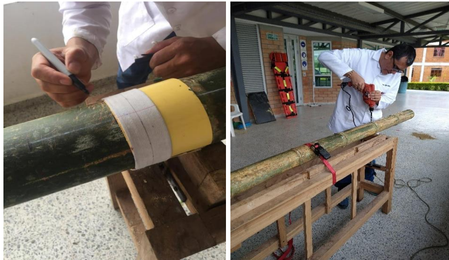
Figura 10. Marcación y perforación de orificios en probetas.
