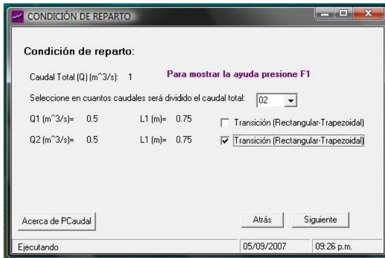
**Figura 14. Ventana condición de reparto para sección trapezoidal**
