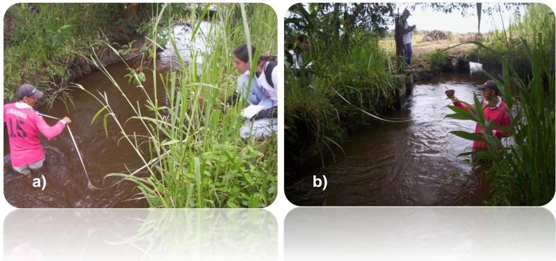
**Fotos 4. a) Sitio de proyección para Partidor en el canal El Playón (La Ye) y b) medidas para la sección del vertedero de cresta aguda**
