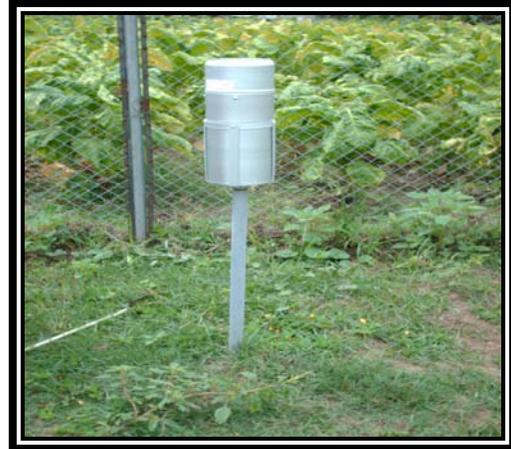
Foto 14. Pluviómetro tipo Hellman
