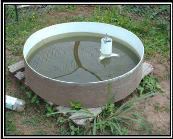
Foto 13. Tanque Evaporímetro Clase A
