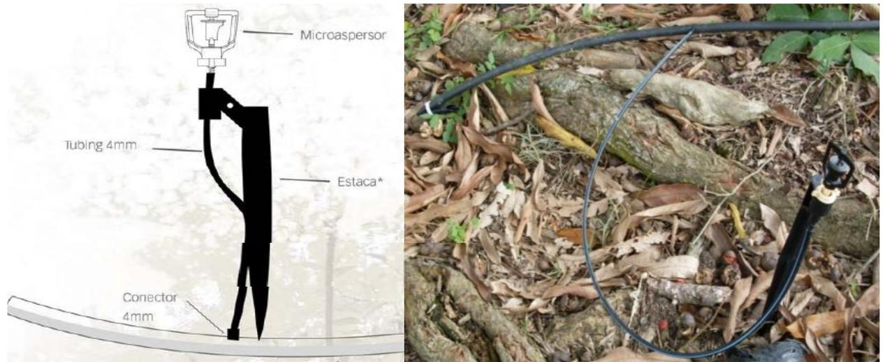
Fig. XI. Componentes e instalación del microaspersor.
