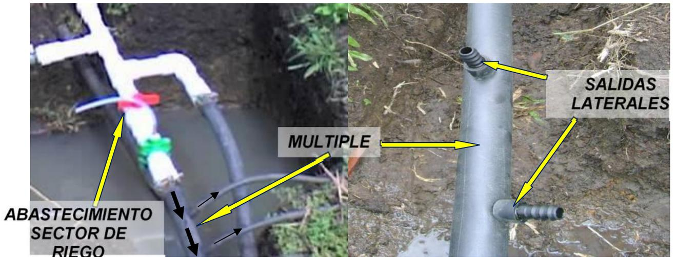
**Fig. VIII. Conexión de Montaje de reparto y salida de la distribución de la manguera Lateral.**
