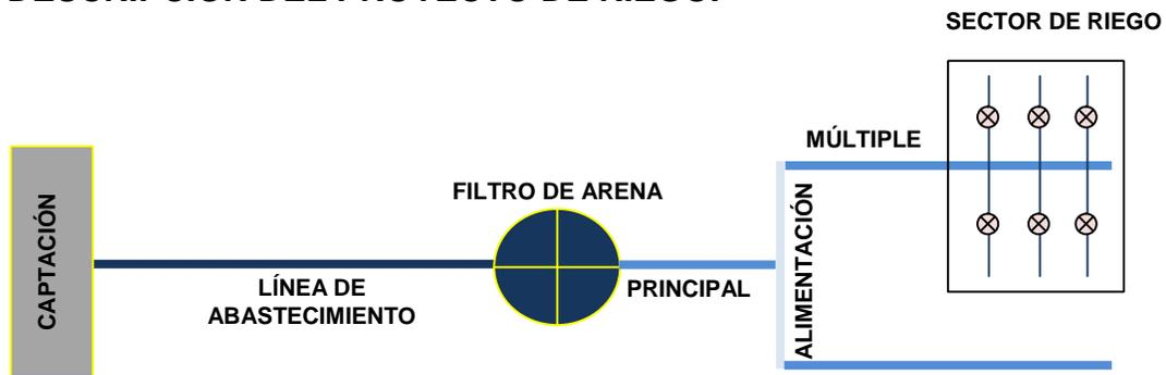
**Fig. I. Esquema de la distribución y componentes del sistema de riego en general.**
