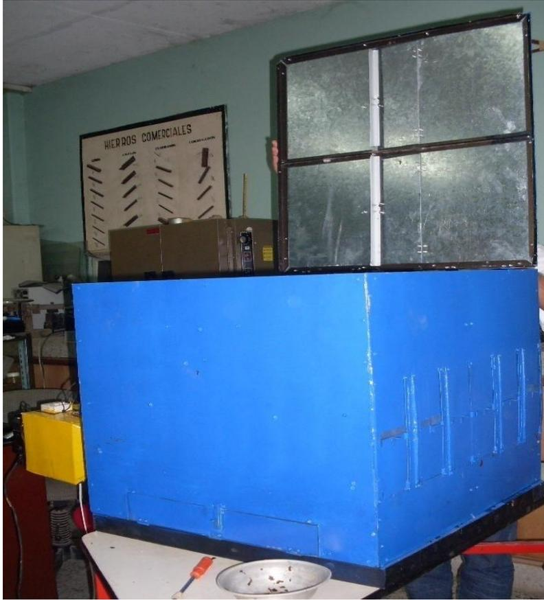
ANEXO C. Vista lateral del silo secador cargado con grano húmedo
