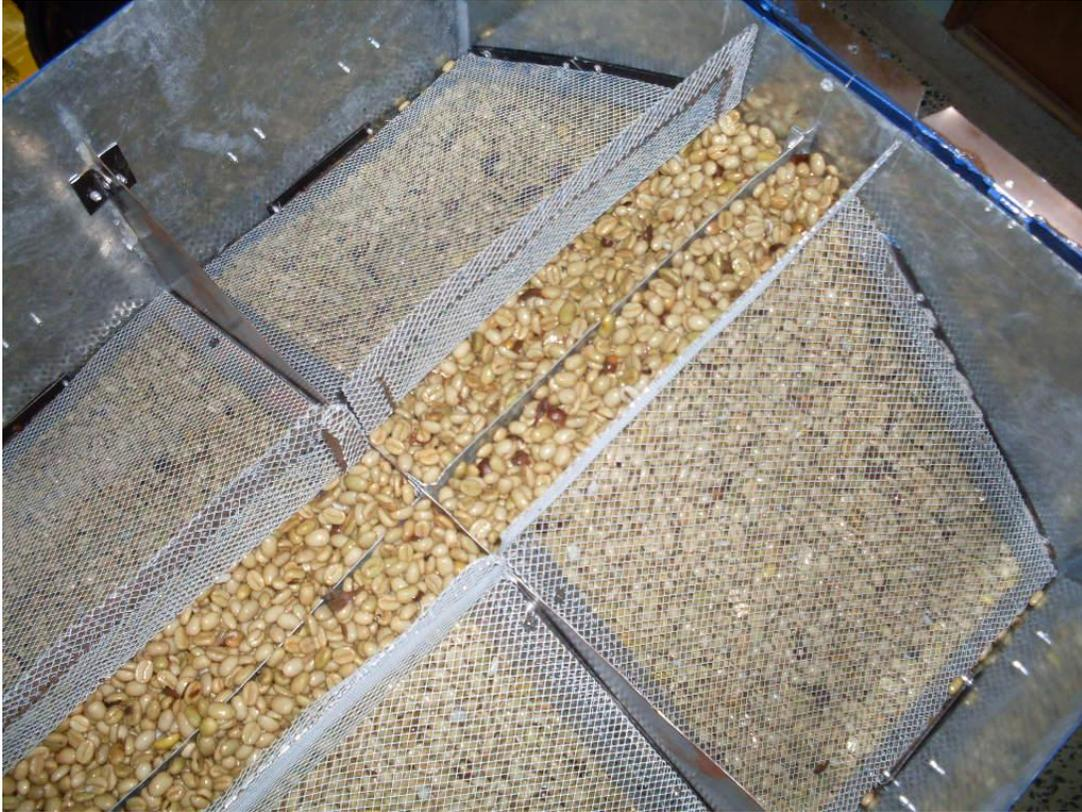
ANEXO E. Apertura de compuertas de descarga del silo secador
