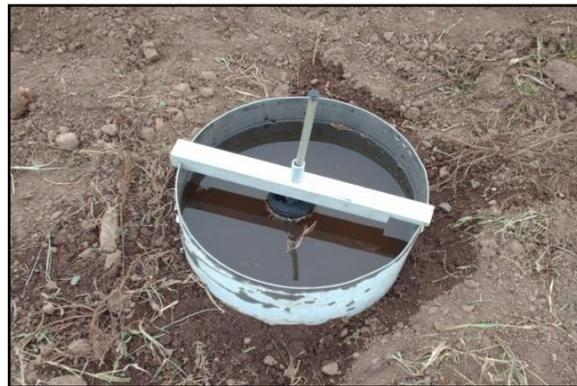
Foto 3. Montaje Prueba de infiltración.
