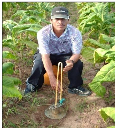
*Foto 4. Montaje Prueba Conductividad hidráulica.*
