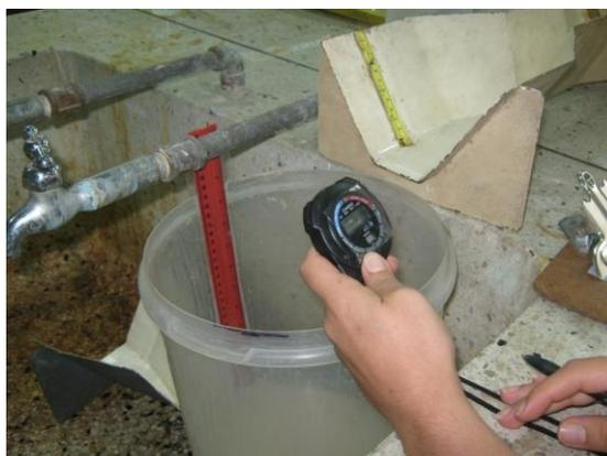
**Foto 8.** Registro de tiempo y toma de altura del agua en canaleta WSC y balde,
