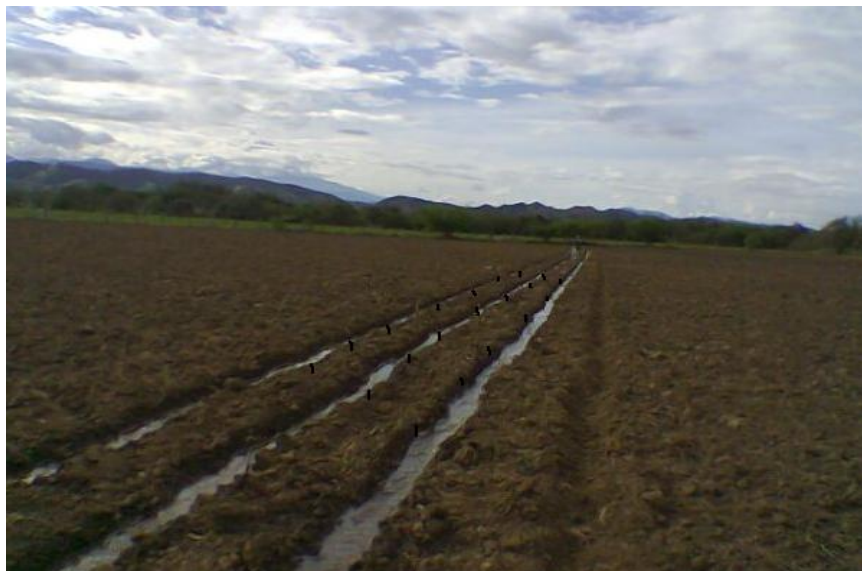
Figura 3. Ubicación de estacas cada 10 m a lo largo de los surcos
