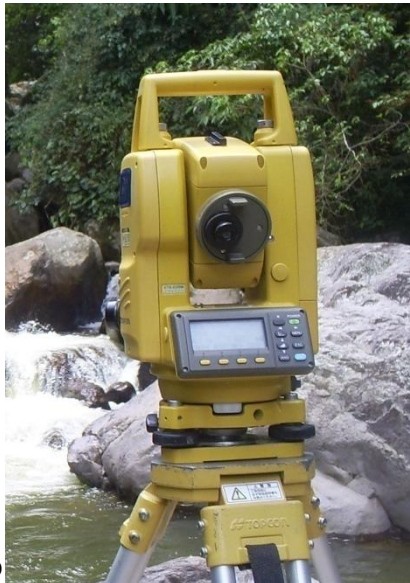
Foto N° 2. Estación Total TOPCON GTS 239W
