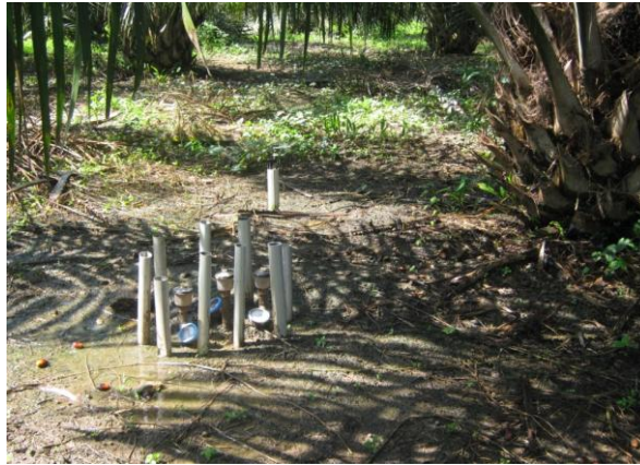
Foto 14. Localización de tensiómetros.
