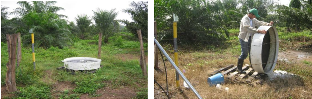
Foto 10. a) Tanque Evaporímetro tipo A y pluviómetro y b) mantenimiento al tanque.
