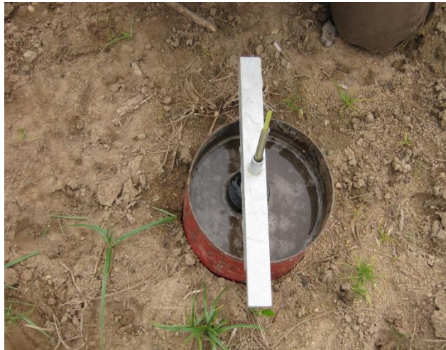
FIGURA 16. Prueba de infiltración con anillo infiltrómetro.
