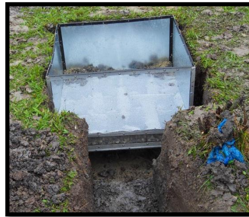
Foto 12. Lisímetro en proceso de instalación en campo.
