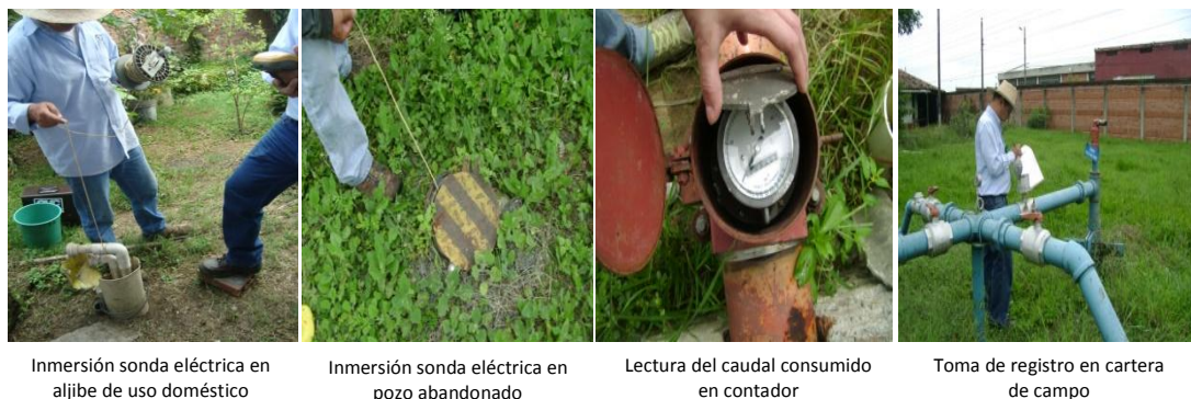
Figura 13. Procedimiento medición nivel freático
