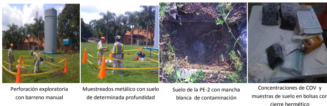
Figura 15. Procedimiento resumido del muestreo de suelo. (Fuente: Informe técnico presentado por Hidrogeoambiental. 2008)
