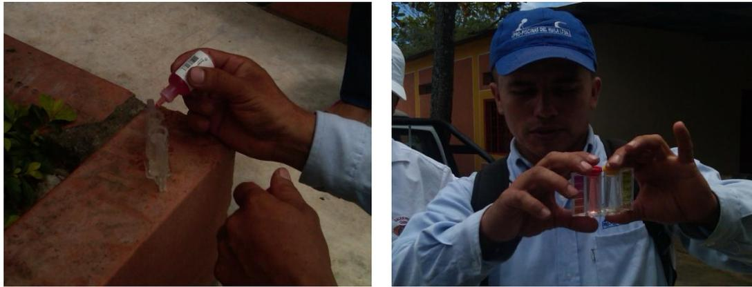
**Figura 4.** Manejo de equipo test kit de pH y cloro.
