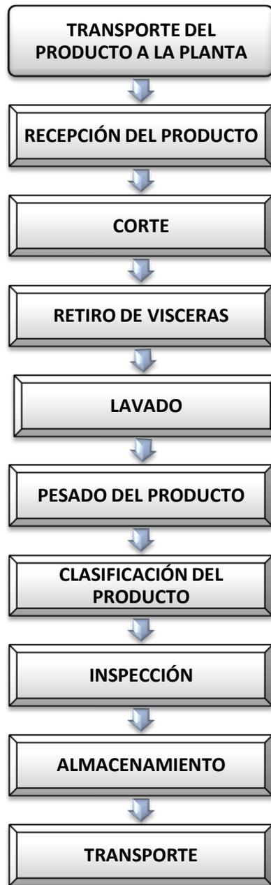
**Figura 26.** Diagrama de flujo del proceso de evisceración de Tilapia roja en la sala de proceso EL CAQUETEÑO.
