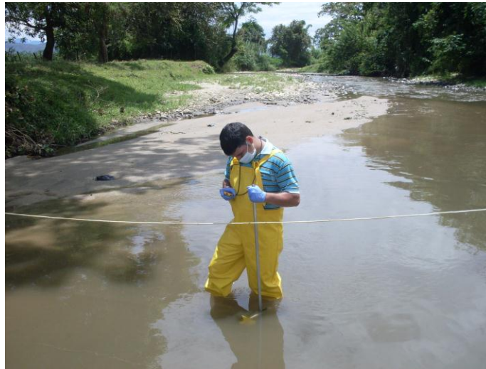
Figura 39: Medida de la velocidad con molinete
