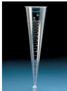
Figura 25: Cono IMHOFF Rotulado en mm
