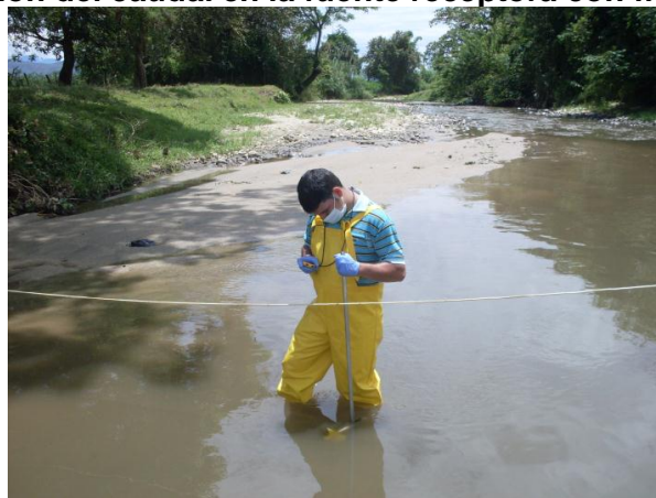
Figura 29: Medición de caudal con Molinete en el Río Frío
